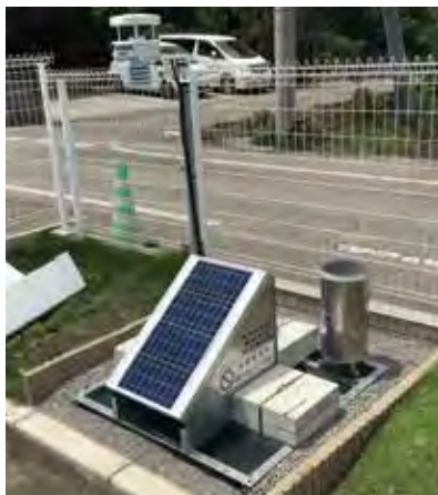
設置例：風向き、風速などは 36 時間先のピンポイント予測ができ、農業散布の際の近隣トラブルを回避できるほか、積算気温、雨量などのデータ蓄積・解析によって農作物の収穫適期の見極めが可能に
