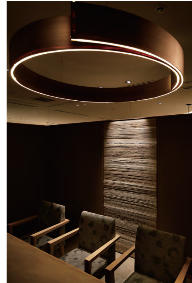
曲げわっぱの技法を用い、LEDを入れた「八芳園槐樹」の大型照明器具。「α(alpha)」の経験から、この発想に繋がった。
