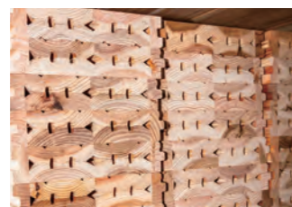
宮崎の杉の端材（周縁部分）を使った中空パネルによる製品開発（良品計画+内田洋行）
