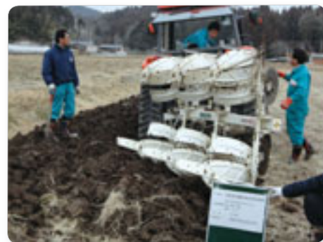
JAそうま：反転耕による除染実験
