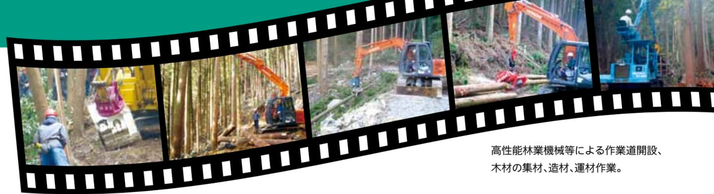
高性能林業機械等による作業道開設、木材の集材、造材、運材作業。
