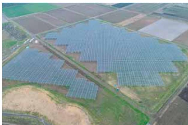
「匝瑳メガソーラーシェアリング」は、2017年3月から設備容量1MWの大規模ソーラーシェアリング発電所を運営。設置場所はもともと耕作放棄地だったことから、大豆や麦などの穀物類を中心に作付けしながら土壌改良を進めている。
