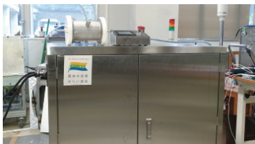
実証実験中の衝撃波破碎機
