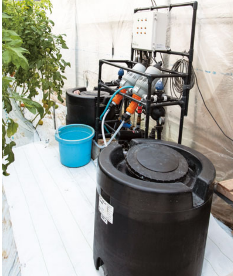
AI灌水施肥システム『ゼロアグリ』本体。点滴チューブを通じて、クラウドから自動算出される最適量の培養液を自動供給する。
